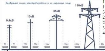
10 м для линий напряжением до 10 000 В 15 м для линий напряжением до 20 000 - 35 000 В
