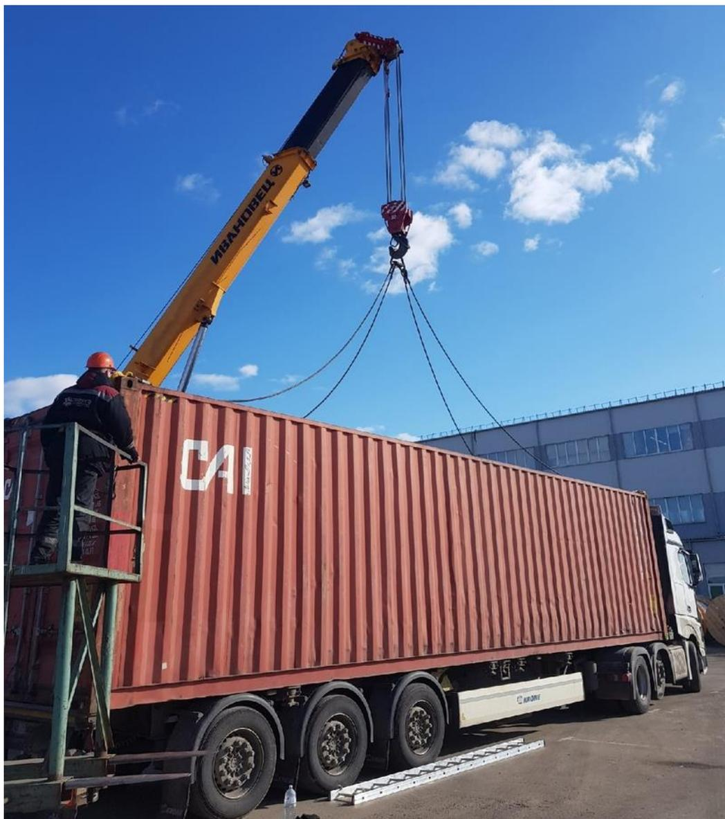
Травмирование пострадавшего произошло при выполнении работ по погрузке контейнера на транспортное средство с использованием автомобильного крана КС-5576К, зарегистрированного в Витебском областном управлении Госпромнадзора. Стропальщик после опускания машинистом крана контейнера на платформу автомобиля приставил лестницу к контейнеру и начал подниматься по ней для снятия крюков стропа с проушин контейнера.
